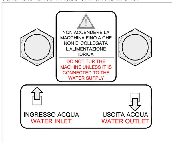
Per sapere quale attacco usare (entrambi da 3/4") come ingresso o scarico acqua è sufficiente seguire le indicazioni riportate in figura (analoga etichetta si dovrebbe trovare in corrispondenza degli attacchi dell'alimentazione idrica).
