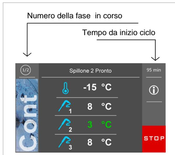
Durante l'esecuzione del ciclo, ogni volta che si richiude la porta, viene eseguito il controllo sull'effettivo inserimento dei vari spilloni e il ciclo termina solo quando tutti gli spilloni inseriti raggiungono la temperatura voluta.
