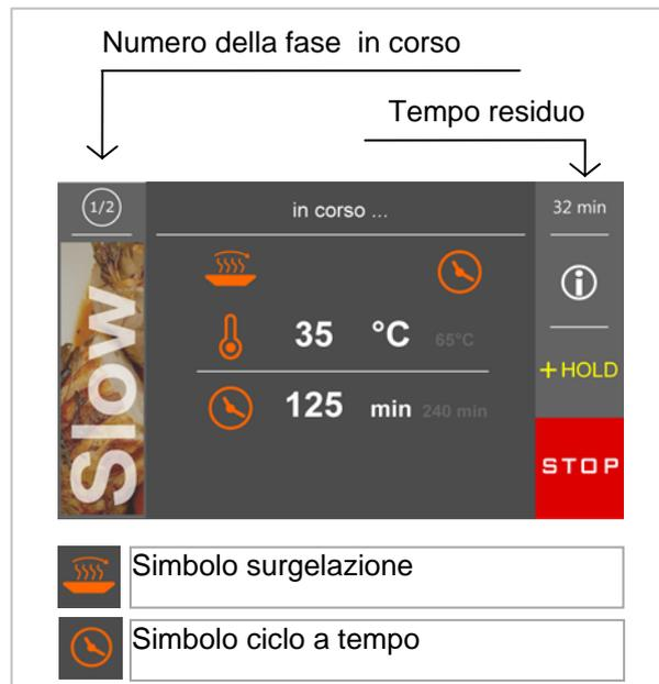
Premendo in corrispondenza dell'area **i** è possibile visualizzare la temperatura letta dalle varie sonde, lo stato degli ingressi / uscite e gli allarmi memorizzati dal sistema.
