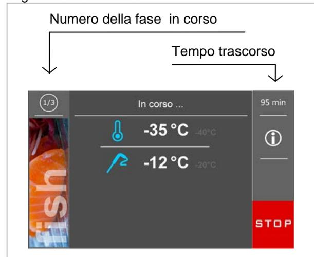
Premendo in corrispondenza dell'area è possibile visualizzare la temperatura letta dalle varie sonde, lo stato degli ingressi / uscite e gli allarmi memorizzati dal sistema. Per interrompere il ciclo in corso premere per almeno tre secondi in
