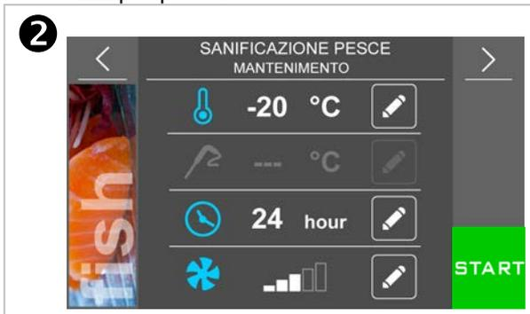
Premendo l'area -20 °C è possibile modificare la temperatura di lavoro della cella nella fase di mantenimento.
