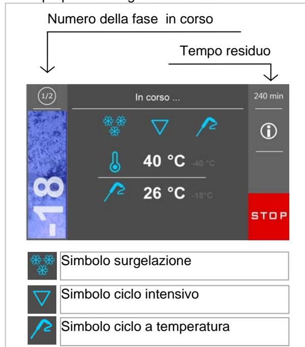
Premendo in corrispondenza dell'area
