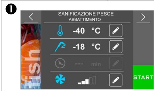
Premendo l'area -40 °C è possibile modificare la temperatura di lavoro della cella nella fase di abbattimento.
