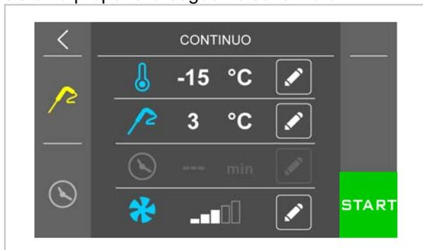
Premendo l'area -15 °C è possibile modificare la temperatura di lavoro della cella.
