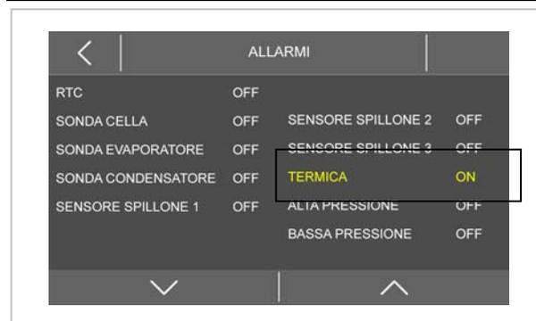
Nel caso di funzionamenti anomali che portassero al superamento dei limiti di assorbimento di corrente previsti da parte dell'impianto elettrico, interverrà un relè termico, che arresterà la macchina.
