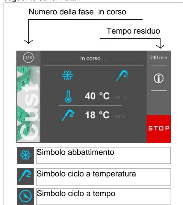
Premendo in corrispondenza dell'area è possibile visualizzare la temperatura letta dalle varie sonde, lo stato degli ingressi / uscite e gli allarmi memorizzati dal sistema. Per interrompere il ciclo in corso premere per almeno tre secondi in
