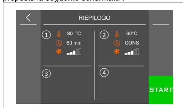
Se è stato selezionato un ciclo di lenta cottura abbinato ad un ciclo di abbattimento intensivo (HARD) verrà proposta la seguente schermata
