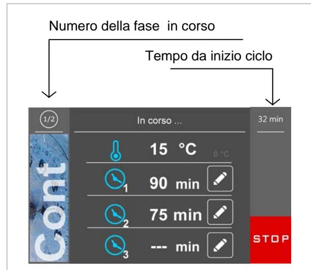
Il ciclo si avvia attivando solo il primo timer; c'è la possibilità di impostare fino a tre timer separati. I timer si impostano premendo l'area matita e impostando un tempo mentre il ciclo è già in corso.
