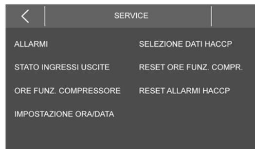
Per l'accesso al menu "reset ore funzionamento compressore" e "reset allarmi HACCP" è necessario inserire la password **149**.
