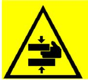
Al fine di evitare scottature o schiacciamento degli arti, è assolutamente vietata la rimozione, anche temporanea, dei pannelli di protezione e dei sistemi di sicurezza!
