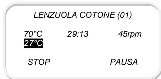
La parte finale di un ciclo avviene senza calore (fase di raffreddamento) per assicurarsi che gli articoli vengano sottoposti ad una temperatura che garantisca che non verranno danneggiati.
