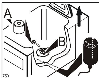
Questo dispositivo di sicurezza, costituito da un magnete [1] di tipo approvato e da un contatto magnetico [2] ha lo scopo di evitare gli infortuni causati dalla partenza accidentale dell'agitatore. Di conseguenza, l'apparecchio non può funzionare senza magnete, se viene rimosso il magnete [A] oppure il coperchio della girante [B] l'agitatore si arresta immediatamente.
