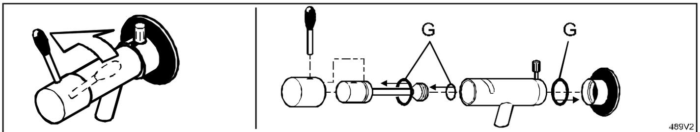
Verificare periodicamente l'integrità delle guarnizioni [G] indicate in figura e sostituirle se risultano rotte, consumate o dilatate (in tale caso le guarnizioni tendono ad uscire spontaneamente dalla loro sede).
