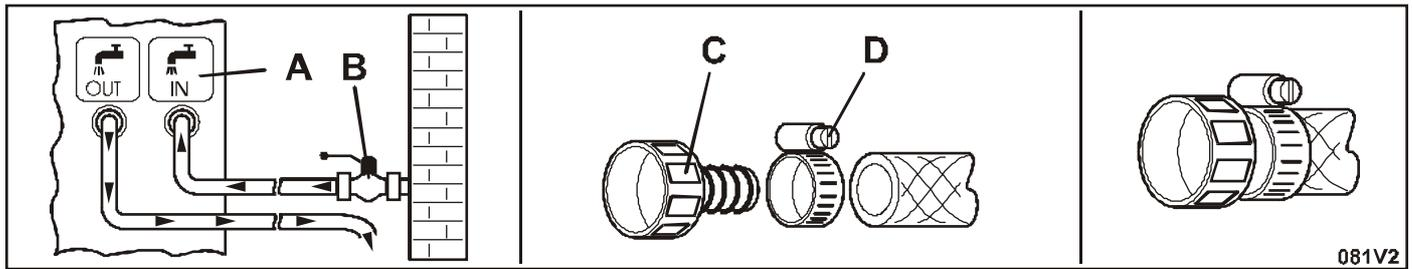
Per il collegamento idrico utilizzare tubi in gomma telata adatti a sopportare pressioni di 15 Bar, interponendo una valvola o un rubinetto [B] **PRIMA** del tubo di mandata; per connettere i tubi ai bocchettoni dell'apparecchio utilizzare portagomma da 3/4" [C] ben fissati per mezzo di apposite fascette [D].
