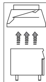
**Nota!** O sistema deve garantir que: a) a descarga de fumos não está obstruída; b) o comprimento do tubo de descarga não é superior a 3 m. Utilize o adaptador para unir condutas de descarga com diâmetros diferentes.
