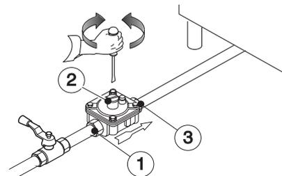
**NOTA!** Estes modelos são concebidos e certificados para utilização com gás metano ou propano. Para o metano, o regulador de pressão no colector foi configurado para 8” w.c. (20mbar).
