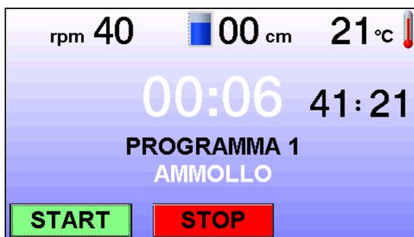
Дисплей показывает выполнение замачивания, Время замачивания показано в центре дисплея.
