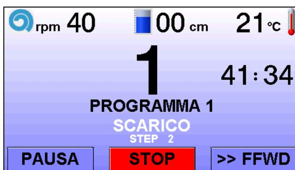
Информация на дисплее позволит вам понять условия эксплуатации машины во время работы. Все параметры могут быть изменены на дисплее нажимая на соответствующие значки. Эти изменения действительны только для текущего цикла.
