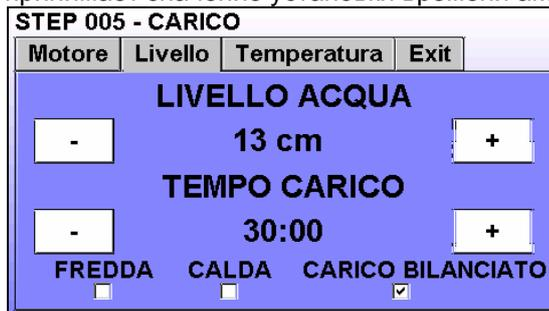
На этой же странице вы можете выбрать тип клапана, которые будут активированы в течение загрузки: если горячая вода, холодная вода или балансировка загрузки. В последнем случае машина загрузит первый 1 см с холодной водой. Затем машина завершает загрузку воды до температуры выбранного уровня.
