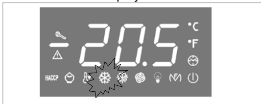
Questo LED indica lo stato (acceso o spento) del COMPRESSORE
