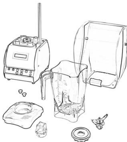
FIG nº10 - Piezas desmontadas para la limpieza
