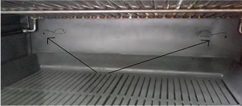
*Puntos de engrase interiores del sistema de elevación*
