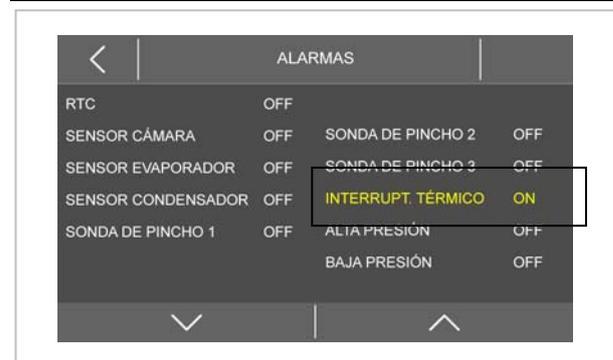
En caso de funcionamientos irregulares que llevaran a la superación de los límites de absorción de corriente previstos de parte de la instalación eléctrica, intervendrá un relé térmico, que parará la máquina. Dicha intervención se indica en la pantalla con la aparición del letrero "HA". En caso de que haya intervenido el relé térmico, el mismo debe ser restablecido manualmente (ver capítulo específico).
