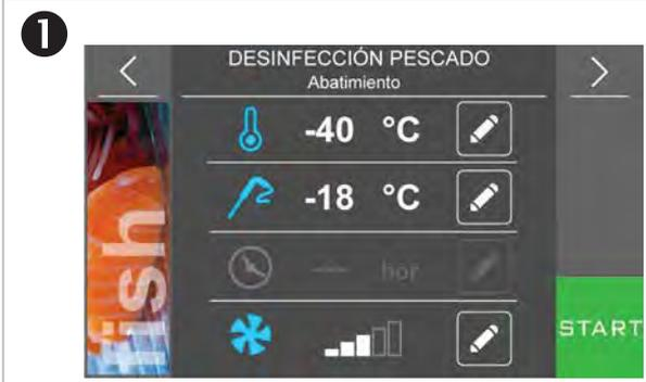
Presionando -40 °C se puede modificar la temperatura de trabajo de la cámara en la fase de congelación rápida.
