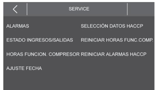
Para acceder al menú “reset tiempo de funcionamiento compresor” y “reset alarmas HACCP” se pide la contraseña **149**.
