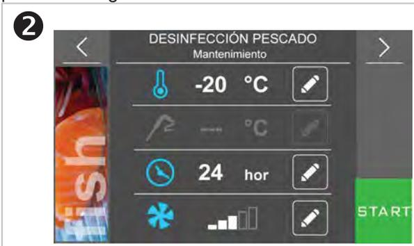
Presionando -20 °C se puede modificar la temperatura de trabajo de la cámara en la fase de mantenimiento.
