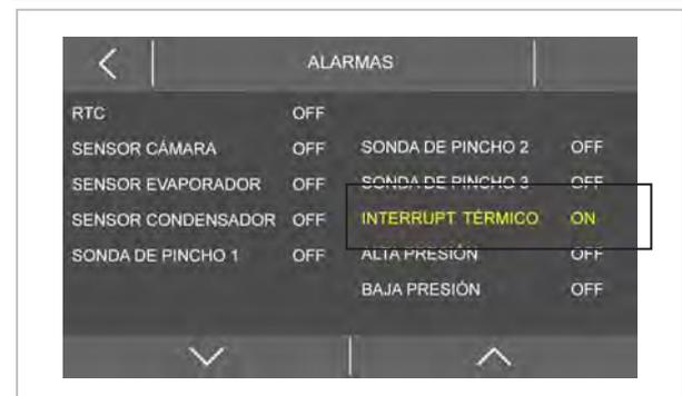
Este microinterruptor situado en el deflector del evaporador desactiva el funcionamiento de la máquina, en caso de apertura del deflector, para inspeccionar el evaporador o los ventiladores. El cierre del deflector con la desaparición sucesiva de la alarma en la pantalla, restablece el funcionamiento normal de la máquina.
