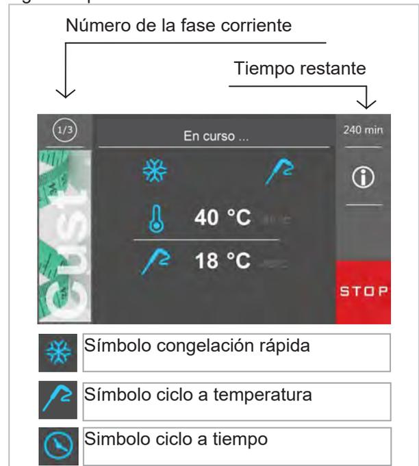
Presionando se puede visualizar la temperatura leída por las sondas, el estado de las entradas / salidas y los alarmas memorizados por el sistema. Para interrumpir el ciclo corriente
