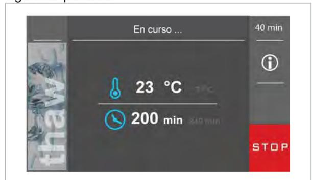
Presionando **i** se puede visualizar la temperatura leída por las sondas, el estado de las entradas / salidas y los alarmas memorizados por el sistema. Para interrumpir el ciclo corriente presionar **STOP** durante 3 segundos por lo menos.
