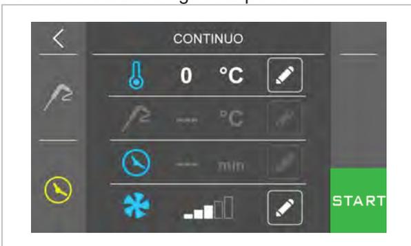
Presionando 0 °C se puede modificar la temperatura de trabajo de la cámara.
