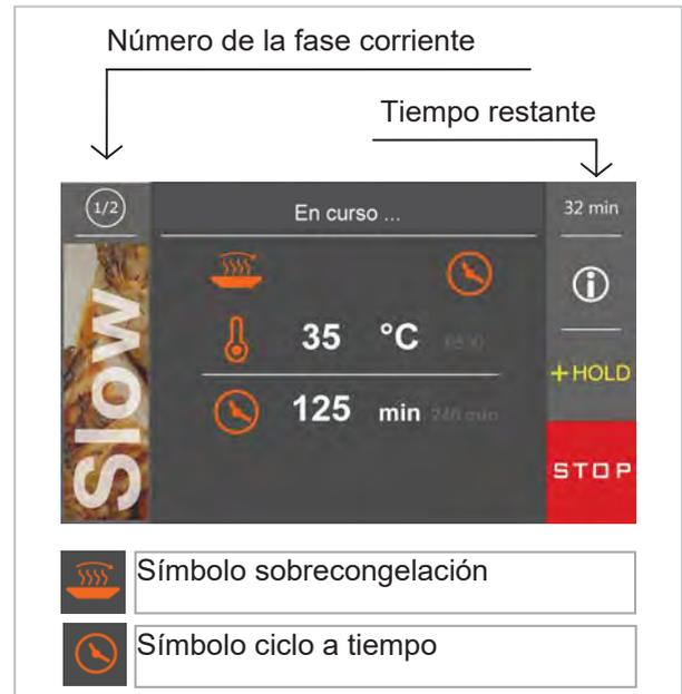
Presionando **i** se puede visualizar la temperatura leída por las sondas, el estado de las entradas / salidas y los alarmas memorizados por el sistema. Si se habilita la fase de
