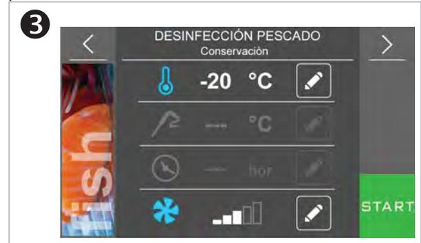
Presionando -20 °C se puede modificar la temperatura de trabajo de la cámara durante la fase de conservación.
