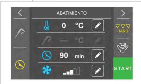
Presionando el área
