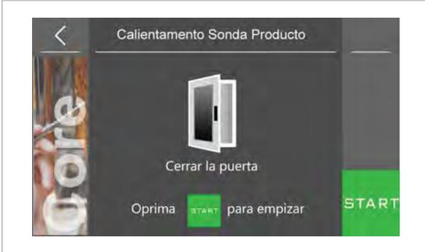
Para iniciar el ciclo se necesita la puerta del congelador rápido, y presionar el área **START**. Durante un ciclo corriente, se visualiza la siguiente pantalla:
