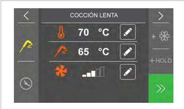
Presionando se puede modificar la temperatura de trabajo de la camera de cocción.
