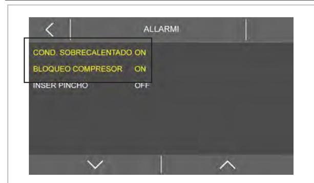
En caso de que haya condiciones ambientales o irregularidades de funcionamiento que provoquen una superación del valor máximo de temperatura en el condensador, se activa la alarma que bloquea el funcionamiento de la máquina. En cuanto se alcance un valor de temperatura aceptable, la máquina puede ponerse en marcha.
