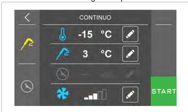
Presionando -15 °C se puede modificar la temperatura de trabajo de la cámara.
