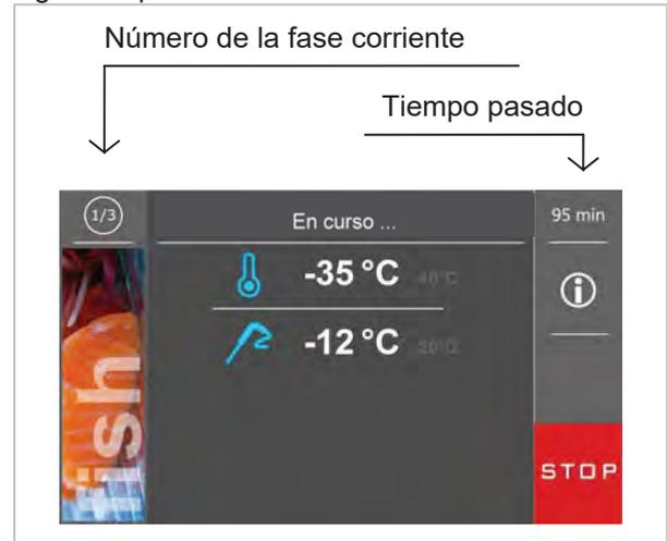
Presionando se puede visualizar la temperatura leída por las sondas, el estado de las entradas / salidas y los alarmas memorizados por el sistema. Para interrumpir el ciclo corriente
