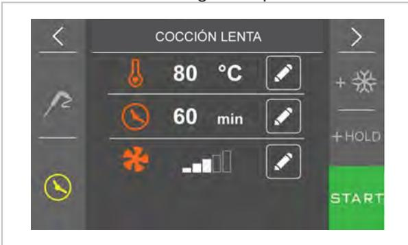
Presionando se puede modificar la temperatura de trabajo de la cámara de cocción.
