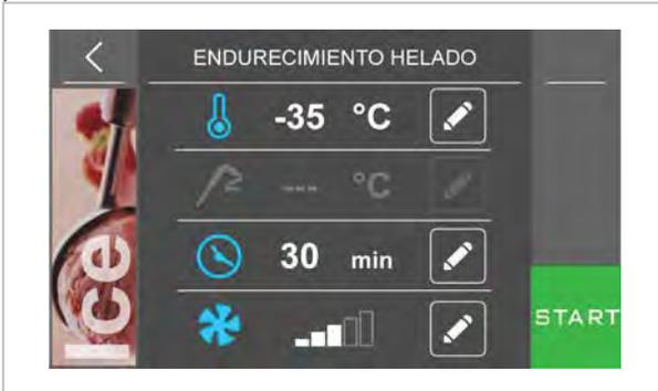
Presionando -35 °C se puede modificar la temperatura de trabajo de la cámara.
