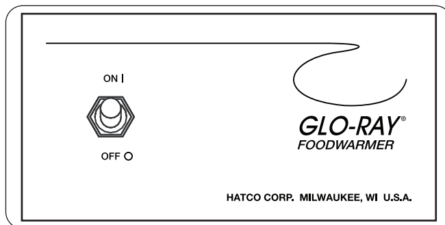
Figura 25. Panel de control con interruptor de encendido y apagado de dos posiciones (I/O).
