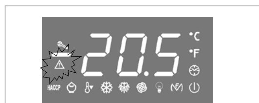
Ce LED indique un état d'ALARME / PANNE.
