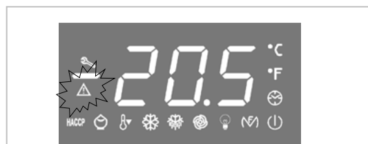
Ce LED indique un état d'ALARME / PANNE.
