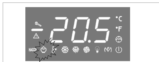
Ce LED indique l'activation de la fonction ENERGY SAVING (économie d'énergie)
