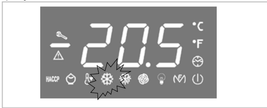
Diese LED zeigt den Zustand (ein oder aus) des VERDICHTERS an
