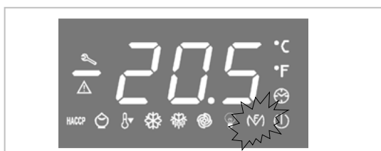
Ce LED indique l'état (allumé ou éteint) de la RESISTANCE PORTE
