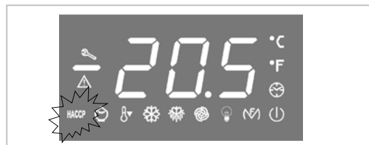
Ce LED indique un état d'alarme HACCP.
