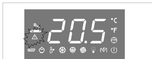
Ce LED indique un état d'ALARME / PANNE.
