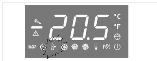
Questo LED indica l'attivazione della funzione OVER COOLING
