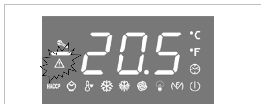
Dieses LED zeigt einen Zustand ALARM / DEFEKT an.
