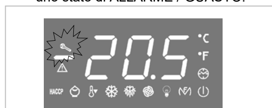
IL LED acceso richiede la pulizia del filtro condensatore.
