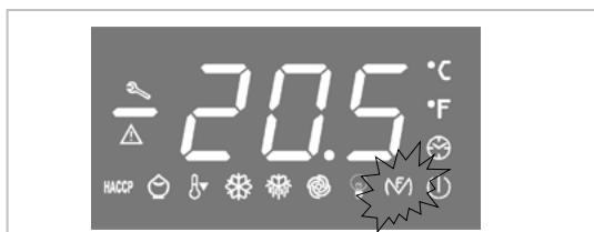
Questo LED indica lo stato (acceso o spento) delle RESISTENZE PORTA
