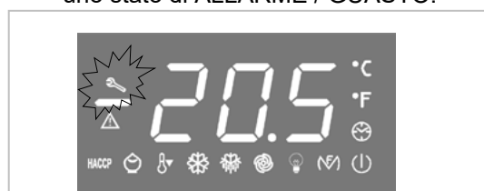
IL LED acceso richiede la pulizia del filtro condensatore.
