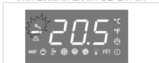
Die LED leuchtet, ist eine Reinigung des Filters Kondensator.
