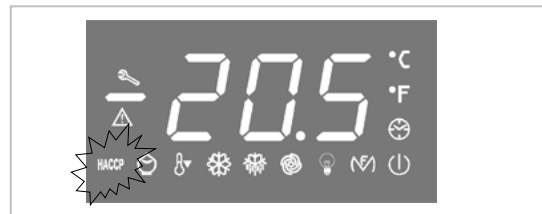
Dieses LED zeigt einen Alarmzustand HACCP an.
