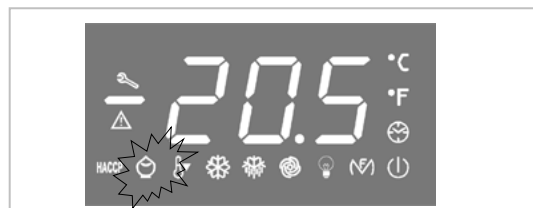
Questo LED indica l'attivazione della funzione ENERGY SAVING
