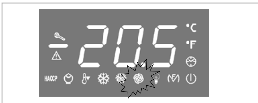
Diese LED zeigt den Zustand (ein oder aus) des GEBLÄSES an
