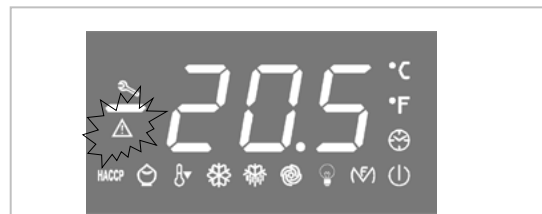
Dieses LED zeigt einen Zustand ALARM / DEFEKT an.
