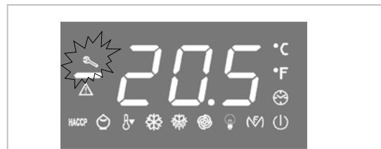
Die LED leuchtet, ist eine Reinigung des Filters Kondensator.
