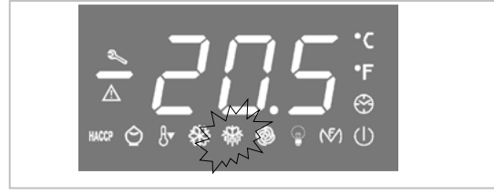
Diese LED zeigt an, dass ein Abtauvorgang läuft
