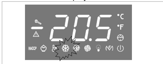
Questo LED indica lo stato (acceso o spento) del COMPRESSORE
