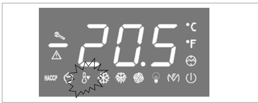
Dieses LED zeigt die Aktivierung der Funktion OVER COOLING an
