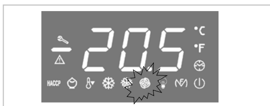
Questo LED indica lo stato (acceso o spento) del VENTILATORE
