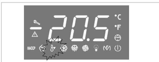
Dieses LED zeigt die Aktivierung der Funktion OVER COOLING an
