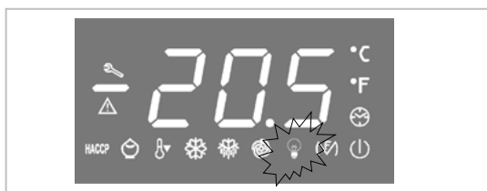
Questo LED indica lo stato (acceso o spento) della LUCE
