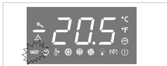
Dieses LED zeigt einen Alarmzustand HACCP an.
