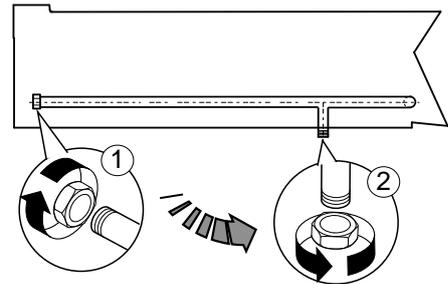
Une fois l'installation effectuée, contrôler les raccords avec une solution d'eau savonneuse pour vérifier l'absence de fuites.
