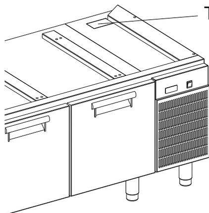
Pour raccorder le système d'écoulement du gril au tuyau d'évacuation, enlever le panneau prédécoupé "T".
