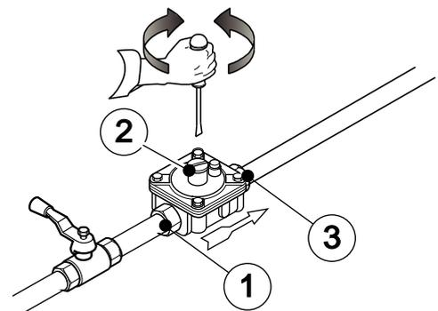
**MARCHÉ AUSTRALIEN** : le régulateur de pression de gaz fourni avec l'appareil doit être monté à l'entrée de l'appareil.
