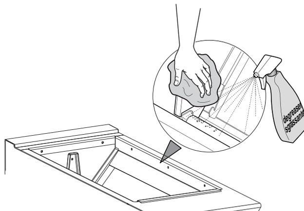
10. Nettoyer les ailettes de la chambre de combustion qui acheminent les jus dans le tiroir de collecte avec un racloir ou un autre ustensile équivalent,
