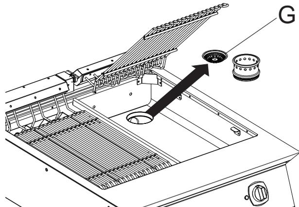
**G.1.6 Nettoyage du réservoir (modèles électriques)**
