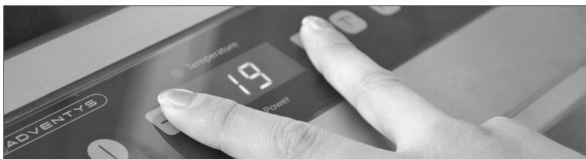
Appuyer sur la touche « T° » si vous souhaitez faire un **réglage en température** (le voyant indiquant l'utilisation du mode de « T° » s'allume), ou bien rester en mode de **réglage de puissance** (le voyant est éteint).
