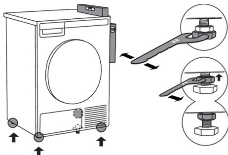
Posizionare l'asciugatrice in modo tale che sia stabile. Utilizzare una livella e bilanciarla sia longitudinalmente che trasversalmente ruotando i piedini regolabili con la chiave inglese n. 22 (massimo 15 mm). Quindi, stringere i controdadi con la chiave inglese n. 17 verso il fondo dell'apparecchio
