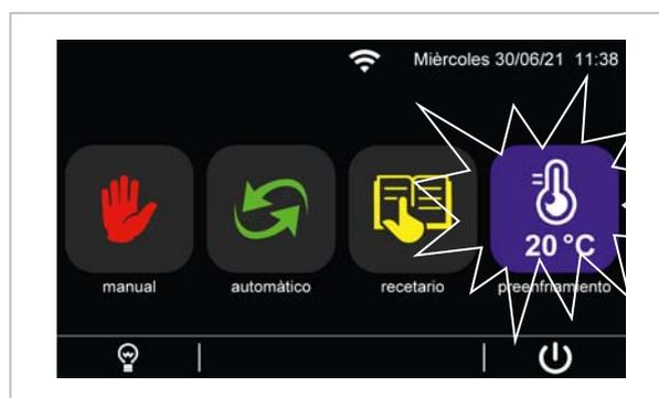
Cuando se alcanza el punto de consigna la primera vez, el controlador emitirá una señal acústica. Si la temperatura en la célula es igual o inferior al punto de consigna configurado, la función de preenfriamiento no se puede activar. La función de preenfriamiento tiene una duración infinita o finaliza cuando se inicia un ciclo, ya sea manual o automático, o cuando se interrumpe presionando el botón **STOP**.
