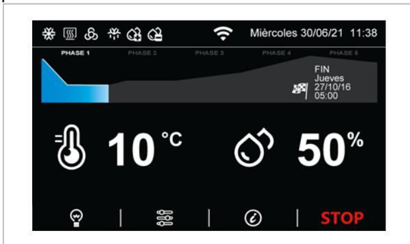
Durante el ciclo automatico, los botónes de control se muestran en la parte inferior de la pantalla:
