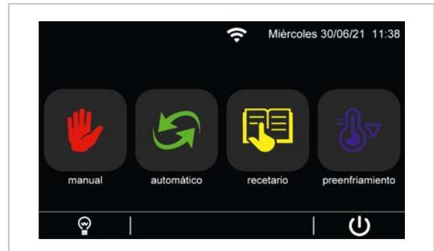
Desde la pantalla de inicio, es posible acceder a los modos de funcionamiento de la máquina, seleccionando el área deseada.
