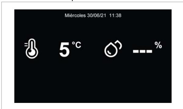
Un toque de la pantalla es suficiente para salir del modo "SCREEN SAVER". Además, una situación de alarma en curso interrumpe el modo "SCREEN SAVER".
