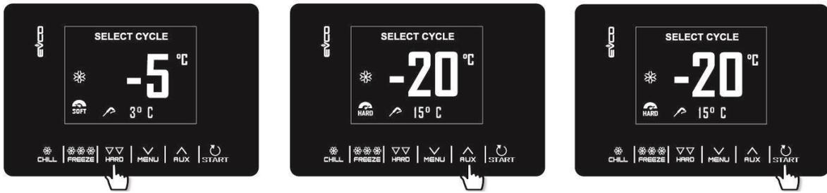
Ejemplo de ciclo de refrigeración en temperatura (pincho), adición de fase hard, rápida modificación del setpoint cámara para la fase soft y start ciclo.
