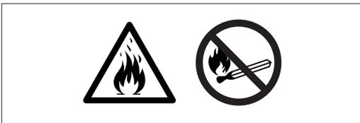
El refrigerante R290 es un gas compatible con el medio ambiente, pero altamente inflamable. Prestar mucha atención durante el transporte, la instalación del aparato y la
