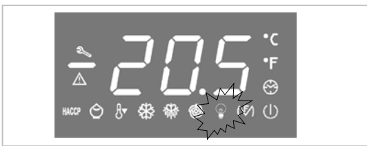
Este LED indica el estado (encendido o apagado) de la LUZ
