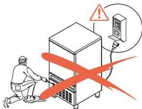
no tocar el aparato con las manos y/o pies húmedos ni con los pies descalzos. Antes de efectuar una operación de limpieza o mantenimiento hay que desconectar el equipo de la red de alimentación eléctrica y desconectar el aparato desenchufándolo con cuidado. Está prohibido quitar las protecciones de seguridad antes de rea-
