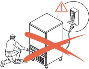
Ne pas toucher l'appareil avec les mains et/ou les pieds mouillés ou nus. Avant d'effectuer toute opération de nettoyage et d'entretien, couper l'appareil du réseau d'alimentation électrique et le débrancher en tirant délicatement sur la prise.
