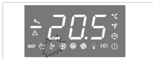
Questo LED indica l'attivazione della funzione OVER COOLING
