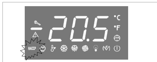
Dieses LED zeigt einen Alarmzustand HACCP an.
