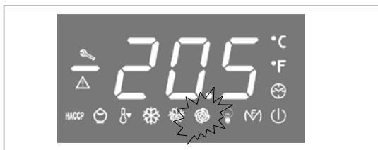
Diese LED zeigt den Zustand (ein oder aus) des GEBLÄSES an
