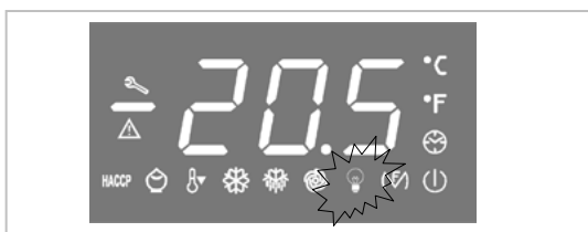
Questo LED indica lo stato (accessorio o spento) della LUCE
