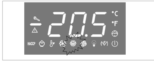
Diese LED zeigt an, dass ein Abtauvorgang läuft
