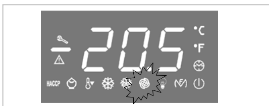
Questo LED indica lo stato (accessorio o spento) del VENTILATORE
