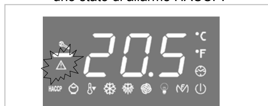
Questo LED indica uno stato di ALLARME / GUASTO.
