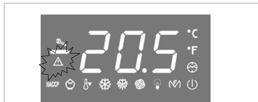
Dieses LED zeigt einen Zustand ALARM / DEFECT an.
