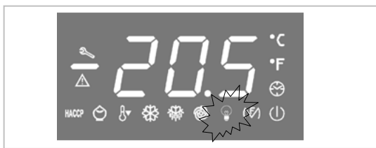
Diese LED zeigt den Zustand (ein oder aus) des LICHTS an
